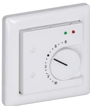
FSTF xx P2L2T Modèle avec sonde, potentiomètre (1 kOhm, max. 0,1 W), 2 diodes électroluminescentes (verte et rouge) et 2 boutons-poussoirs (max. 24 V cc, max. 10 mA)
